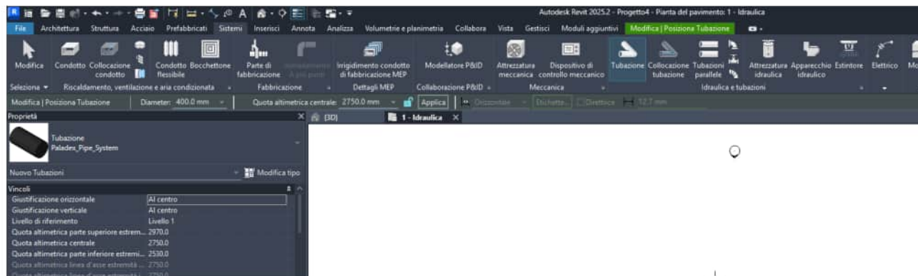
Figura 8 – Menu Sistemi di Revit: selezione e posizionamento della famiglia “Paladex_Pipe_System” tra gli accessori delle reti idrauliche.
